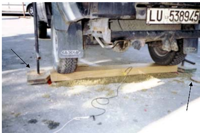
Fig. 3.7 – Esempio di sorgente di onde SH; a) accoppiamento tra massa energizzante e terreno favorito dal carico statico di un automezzo; con le frecce nere sono indicati i pendoli da 30 kg, utilizzati per la generazione delle onde di taglio polarizzate orizzontalmente.
